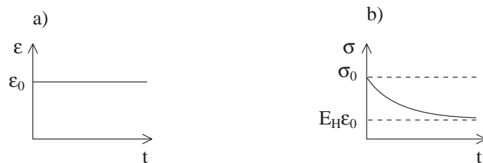
Obr. 3.12. Závislosť deformácie od času (a) a tomu prislúchajúci časový priebeh napätia (b) Zenerovho telesa.
