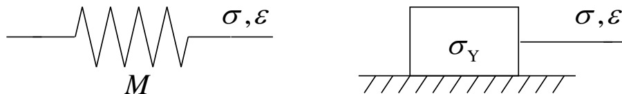
Obr. 10 Reologický model dokonale elastického materiálu – Hookeovo teleso. Reologický model ideálne plastického materiálu – Saint-Venantovo teleso.
